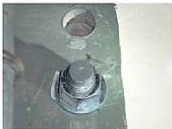
照片 8: 未達規矩之 SMP 螺栓(型號標記不可見)
