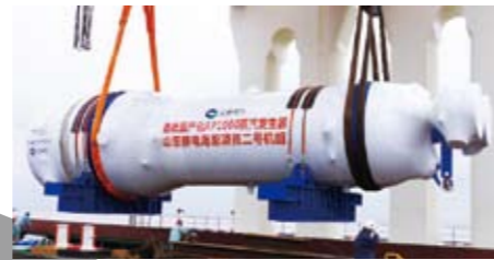
蒸汽发生器 Steam Generator
