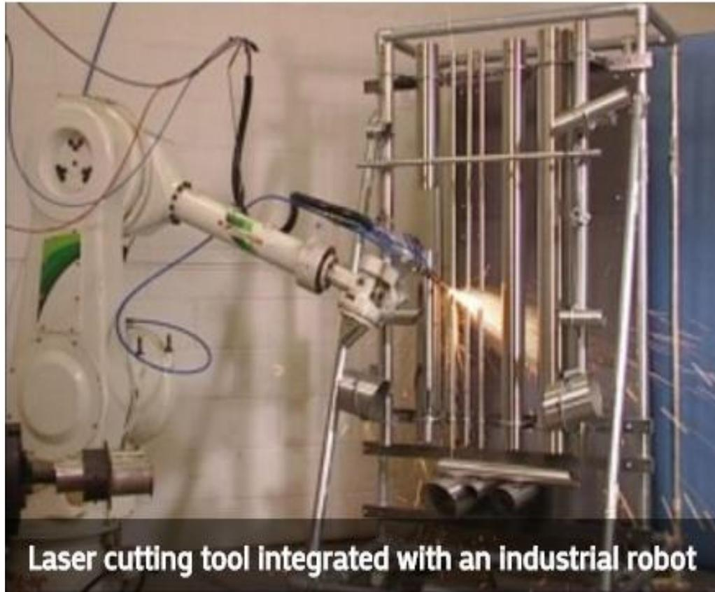
高鐳射切割非常適合不同種類的機械手（蛇形機械手）進行遠端作業。
