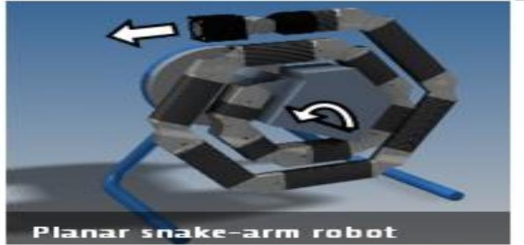
Laser Snake 機器人系統是由 OC Robotics and TWI 共同發展，證明可使用在除役現場執行多功能任務。
