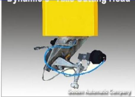
■ 水刀五軸切割系統
